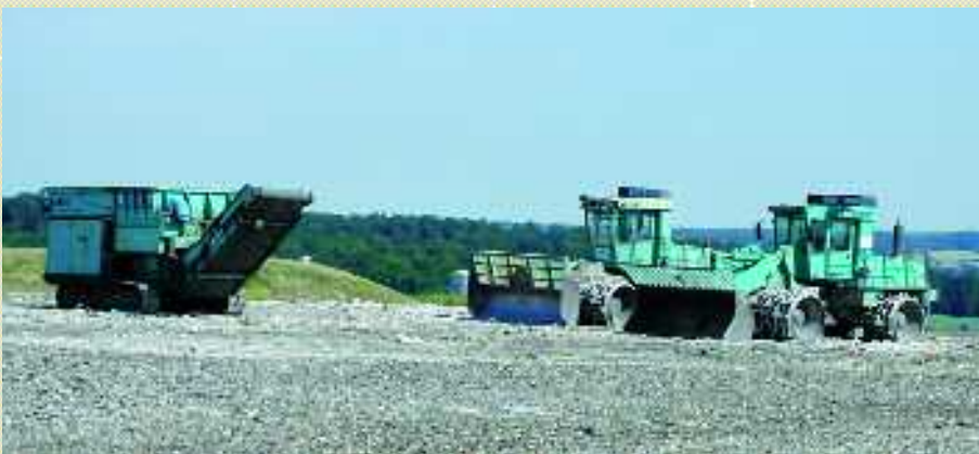
Kompaktoren und Abfallzerkleinerer auf der Deponie Beselich.
