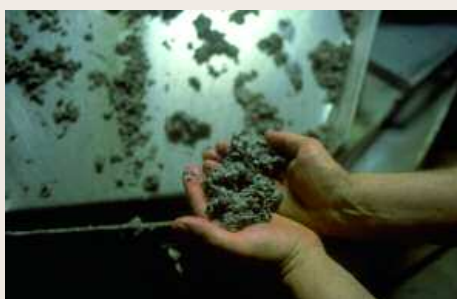
Aus dem braunen Faserbrei werden verschiedene Kartonqualitäten hergestellt. (Fotos: FKN)
