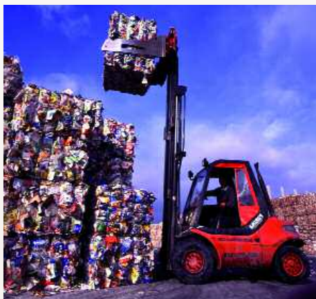
In den Sortieranlagen werden die gebrauchten Getränkekartons zu Ballen gepresst und zu den Recyclinganlagen transportiert.
